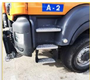
Dado que hay trabajadores que, por su altura, tienen dificultades para entrar y salir de la cabina, ARAVÍA instaló un escalón adicional de acceso a las cabinas de sus camiones. El fabricante supervisó y aprobó el proceso.
