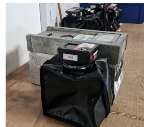
O cofre de metal pesado utilizado a partir de 2005 é substituído em 2016 por um saco de plástico leve com um mecanismo de fecho.
