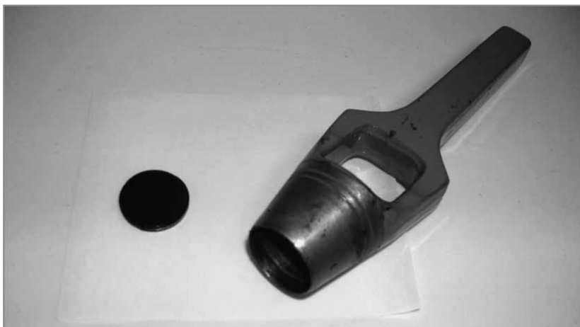
Foto 2. Probeta DSR de 25 mm de diámetro y 2 mm de altura más troquel.
