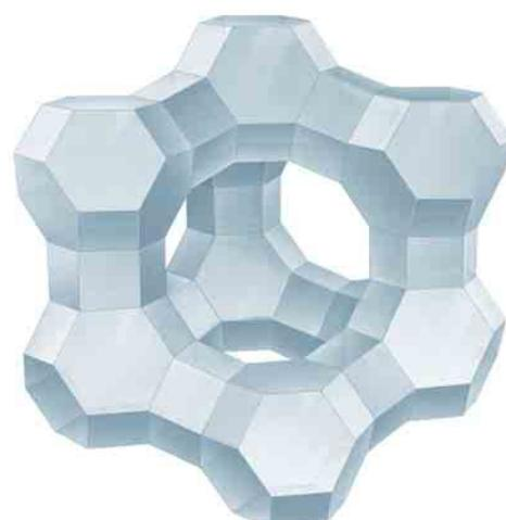
Figura 4. Estructura de zeolita tipo X (Grace Davison, 2010).
