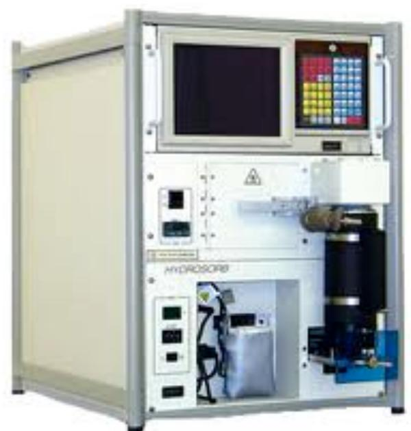
Figura 7. Equipo para la medida de las isothermas de agua.
