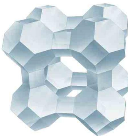
Figura 3. Estructura de zeolita tipo A (Grace Davison, 2010).
