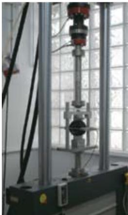
Posteriormente se realizó el ensayo mediante tracción indirecta (ITT), apoyando la probeta sobre una generatriz aplicando una carga de compresión vertical en la generatriz opuesta, midiendo la deformación que sufre la probeta en un plano que
