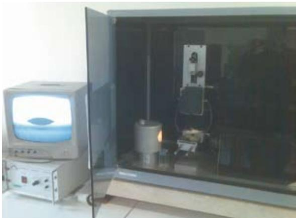
Fig 3. Goniómetro para la determinación de ángulos de contacto.
