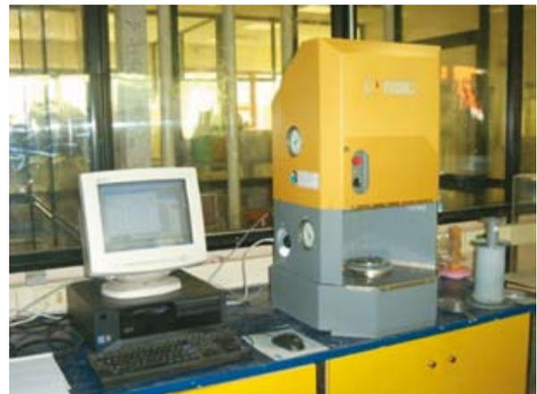
Fig. 4. Compactador Giratorio.
