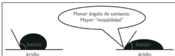
Fig 2. Mejora del ángulo de contacto mediante empleo de tensoactivos.
