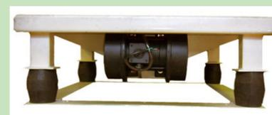
Figura 1. Mesas vibratorias que pueden soportar el dispositivo extrusor.
