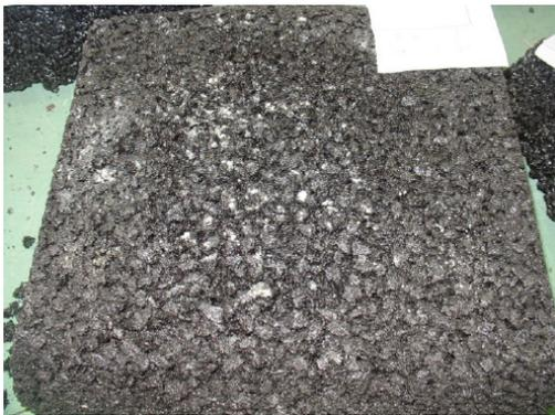
La mezcla es de tipo BBTM 11 B(UNE-EN 13108-2), fabricada en la planta asfáltica de Tuccitana de Contratas (TUCSA) con betún modificado con polímeros PMB 45/80-60C, y áridos traquita con una densidad de referencia de 2,085 g/cm<sup>3</sup>.
